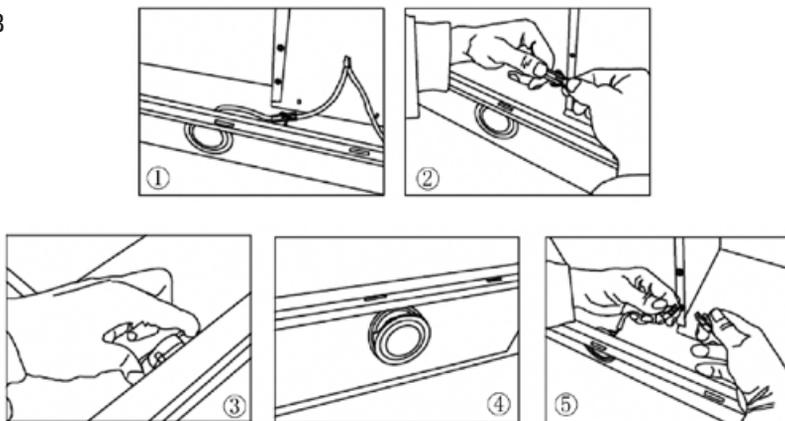
1. Находим провод от перегоревшей лампы подсветки и вытягиваем его из зажимов в месте укладки.
