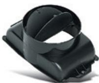
В режиме отвода воздуха антивозвратный клапан препятствует попаданию в квартиру неприятных запахов, находящихся в вентиляционных шахтах. Достигается это за счет створок клапана, которые открываются только при работе вытяжки, когда воздух из кухни выходит в шахту.
